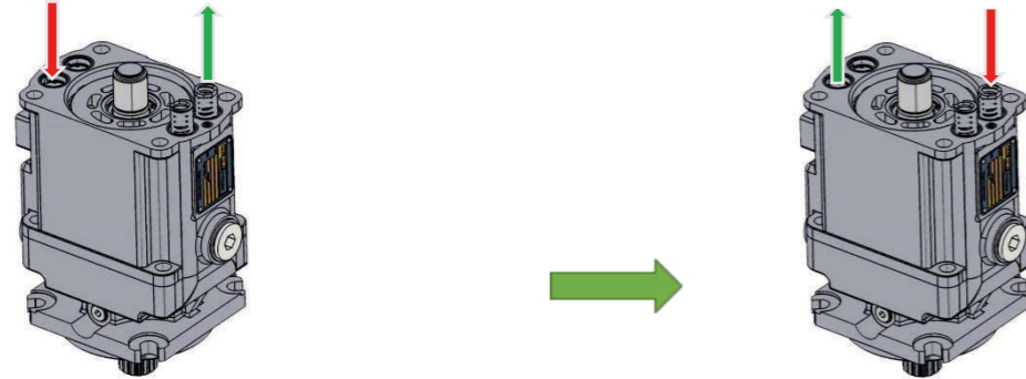
16 Funktionsprüfung der Schrägscheibe (Leichtgängigkeit prüfen)
